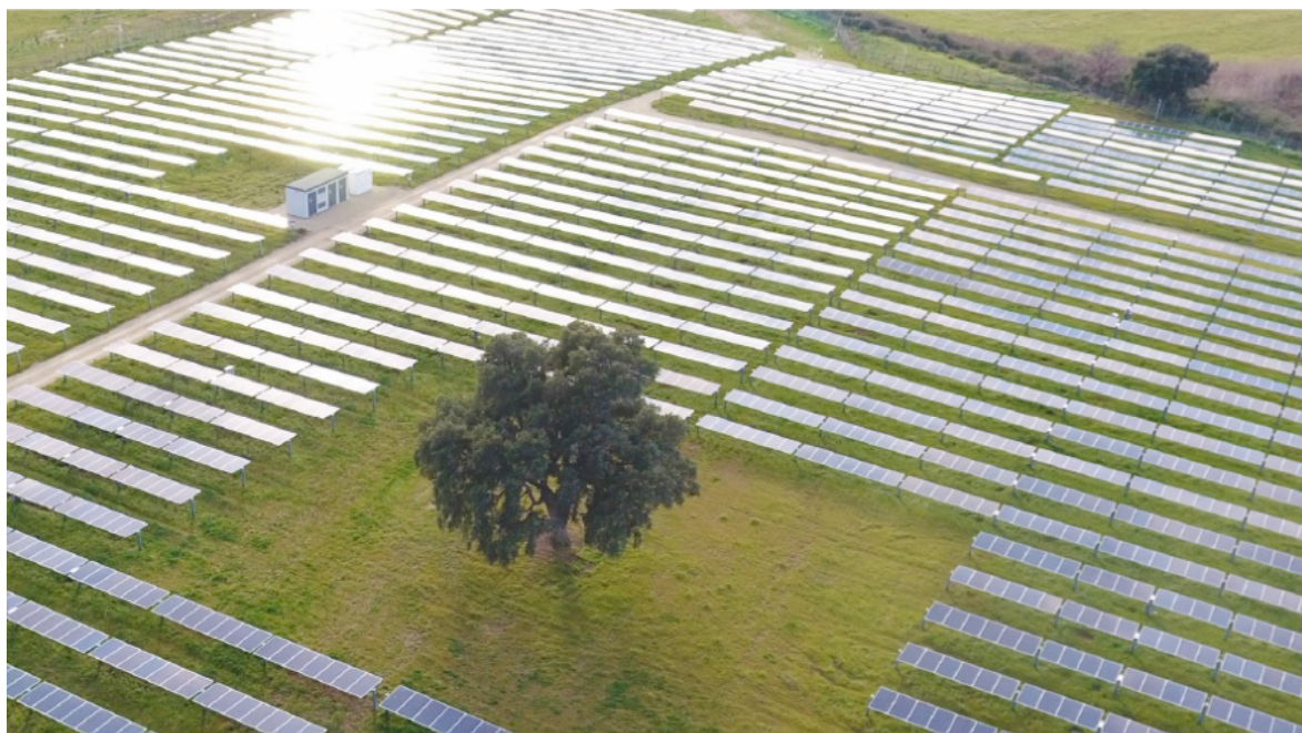
Figura 4 - esempio di impianto realizzato con i tracker proposti e pannelli in configurazione monofilare
